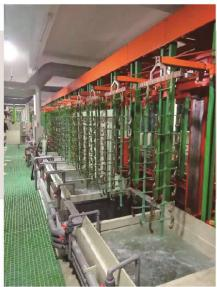
垂直升降电镀线适用于中、小工件的小批量生产,主要用于五金、ABS电镀行业挂镀镍、铬、青铜、银等。全线可采用电动、液压的传动方式,运行平稳可靠、噪音小;可采用电脑自动控制系统,PC可编程序控制器控制,操作动作简单、准确;速度时间可根据电镀工艺的各项技术要求进行任意调控。可设缓冲装置,镀件夹持稳固;大大减少操作人员,提高电镀品质,生产效率高,产量大。
