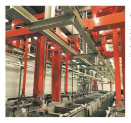
龙门式挂镀生产线适用于五金及ABS镀铜、镍、铬、锌、铝氧化、硬铬及其它先进工艺要求,可根据用户需要满足各种电镀中的功能性及装饰性要求,线结构合理,外形美观、操作方便,并可根据客户要求设计全自动和半自动两种操作,电脑可编程控制的全自动操作系统可用屏幕显示,定位性高。龙门行车行走平稳,全线各道工序实现工序控制,变频调速,适用于各种尺寸的镀槽,是一种适应性较广泛的自动线。
